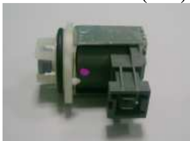
Electrovanne régénération 6W – 4130 ±10ohm (25C°)
