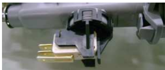
Distributeur Position 1 : Bras supérieur Position 2 : Bras inférieur
