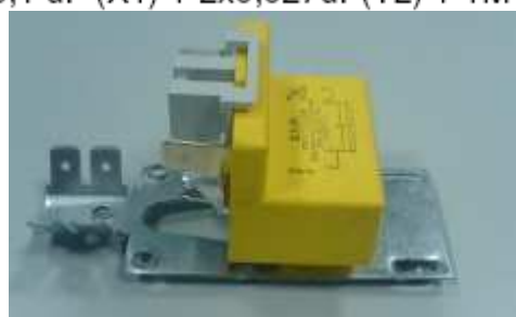
Condensateur Anti-parasite 0,1 µF (X1) + 2x0,027µF(Y2) + 1M Ω
